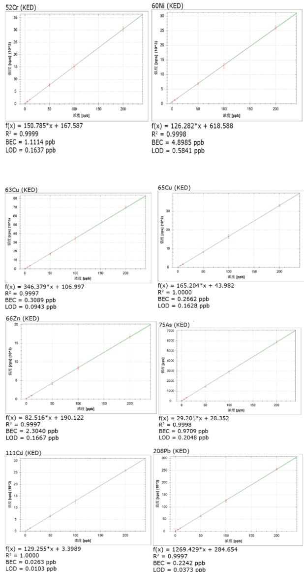
图 2. Cr, Ni, Cu, Zn, As, Cd, Pb 的校准曲线
