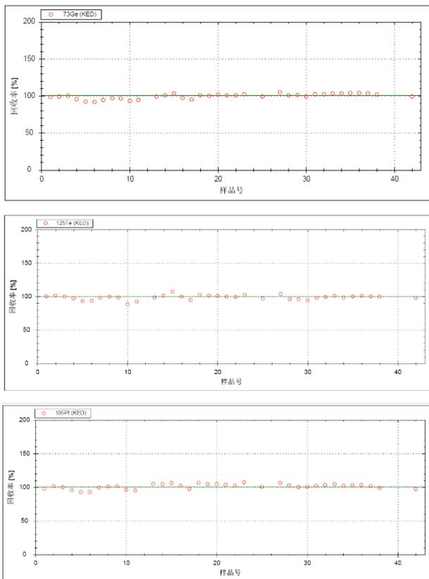
图 3. 连续分析未经稀释的二十多个海水样品溶液，内标回收率极其稳定
